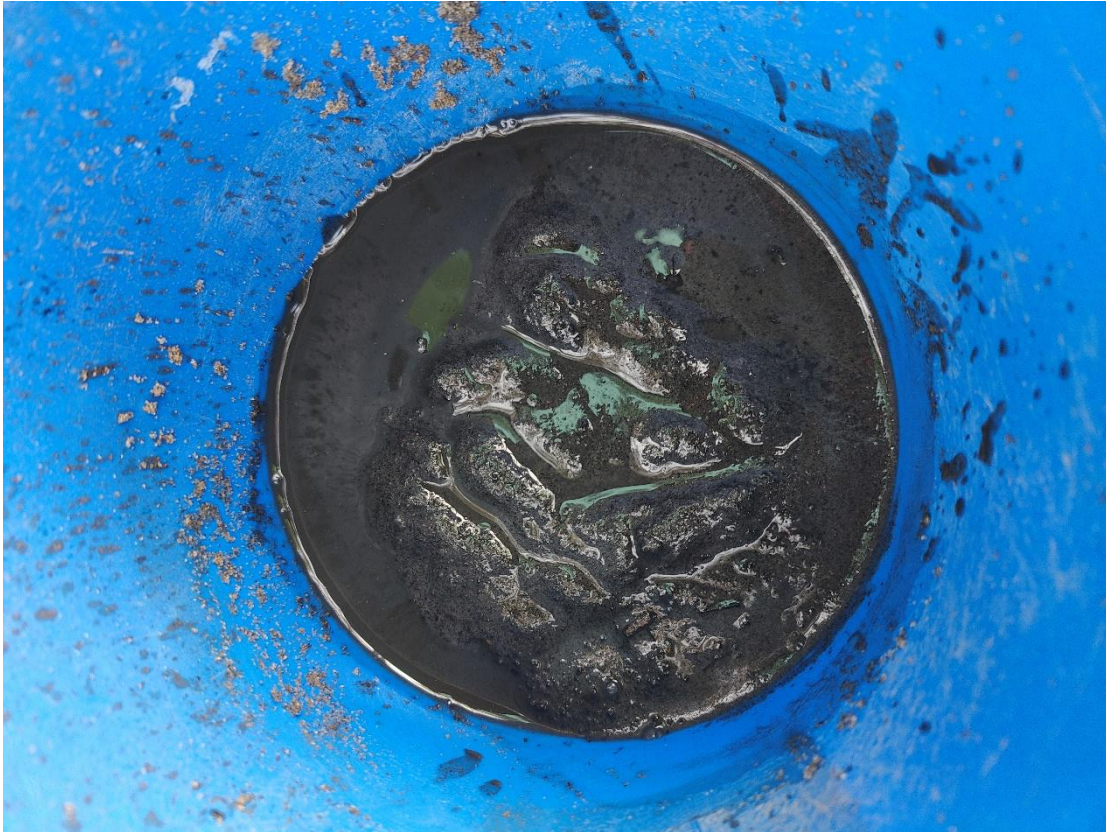
Kuva 5. Näyte "P4 2,5-3", jossa todettiin potentiaalisesti hapanta sulfaattimaata kokonaisrikki- ja hapontuottopotentialin perusteella.
