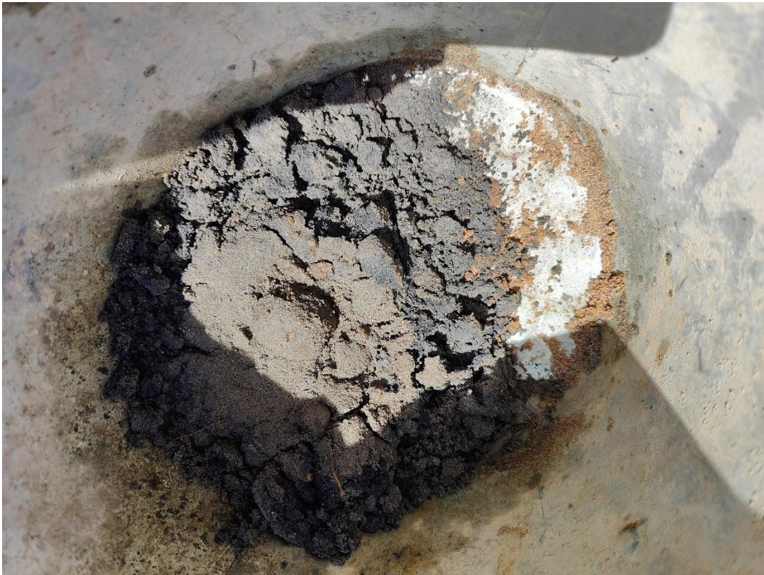
Kuva 1. Näyte "P1 1,5-2", jossa todettiin potentiaalisesti hapanta sulfaattimaata kokonaisrikki- ja hapontuottopotentiaalin perusteella.
