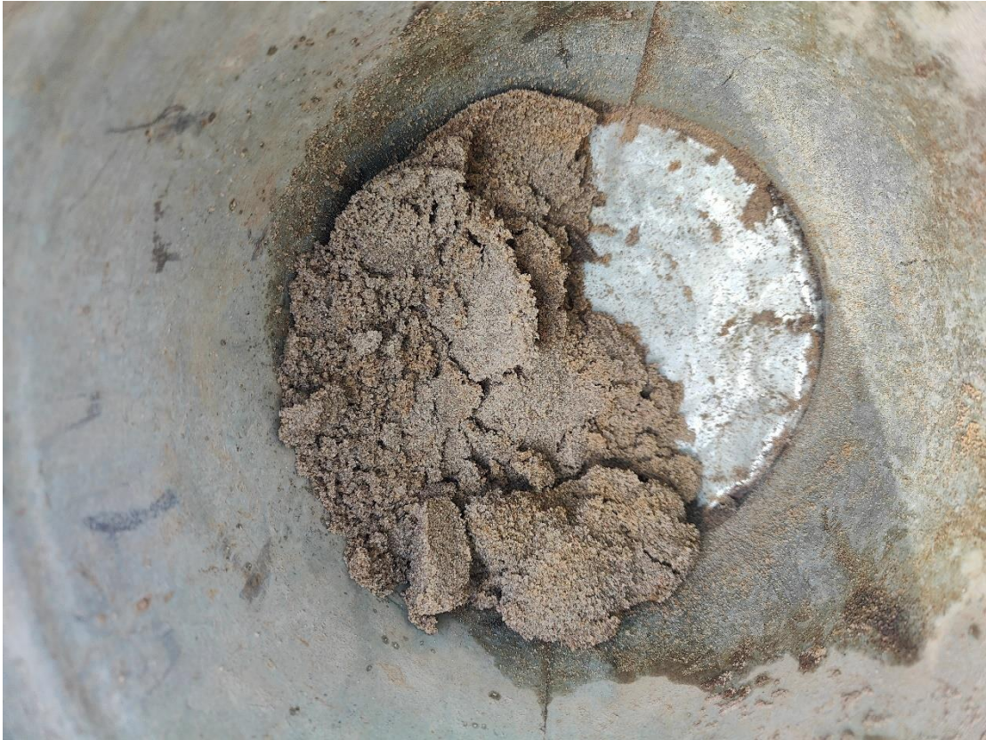
Kuva 3. Pisteessä P3 ei tutkimusten perusteella todettu potentiaalisesti happamia sulfaattimaita. Kuvassa näyte "P3 2-2,5".
